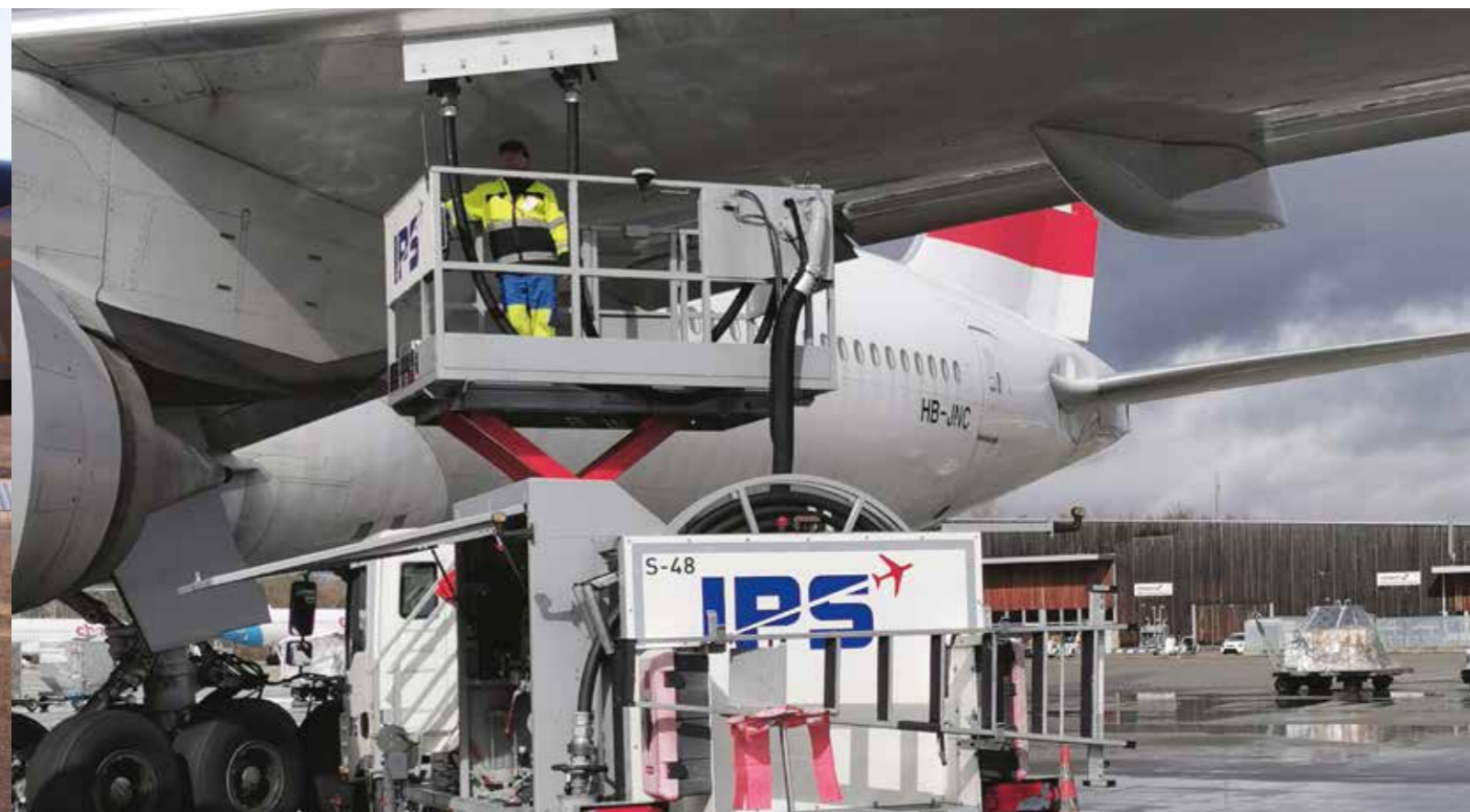
Ravitaillement d'un Boeing 777 à l'aéroport de Zurich. Sa destination: Hong Kong. Selon les conditions, l'avion aura besoin jusqu'à 100 000 litres de kérosène. Le kérosène est amené directement du dépôt voisin de Rümlang au terminal via un pipeline souterrain. De là, un véhicule spécial pompe 2000 litres de carburant par minute dans les ailes de l'avion.
