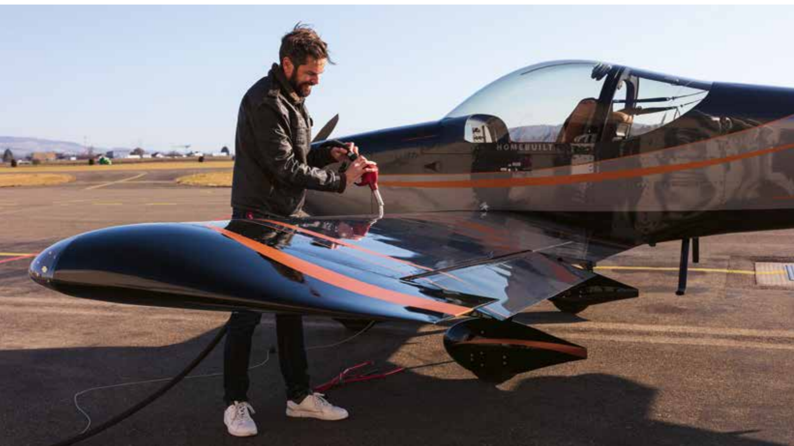
Faire le plein d'un avion: à l'aéroport de Birrfeld (AG), pour le chef du terrain d'aviation, Carlo Ferrari, cela fait partie du quotidien et dure entre 10 et 15 minutes selon le volume de carburant délivré. Un petit avion peut contenir environ 100 à 160 litres de carburant, selon le type, et rester ainsi 4 à 7 heures dans les airs. Environ 230 avions à moteur et planeurs, des avions anciens aux avions d'entraînement les plus modernes, sont basés à Birrfeld.
