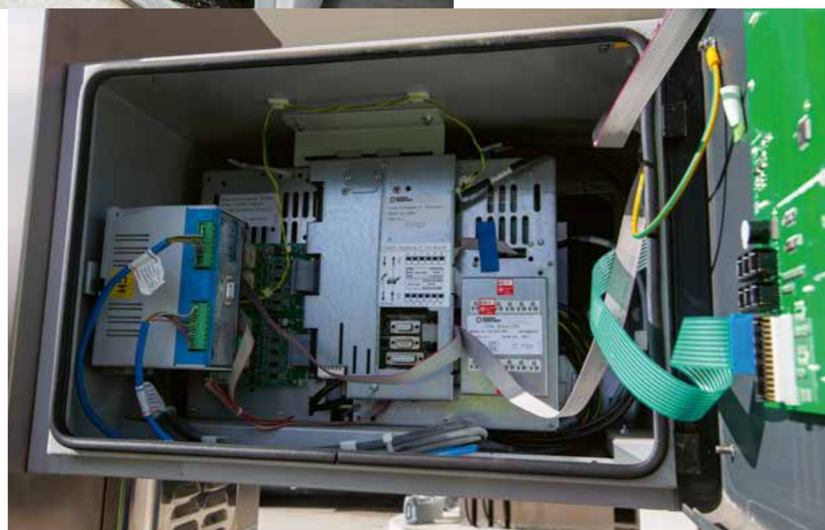
L'information concernant la quantité de carburant pompée est transmise à l'unité de calcul située en haut de la pompe. C'est là que se trouve l'ordinateur qui commande toute la colonne. Celui-ci calcule le prix total du remplissage et bloque la colonne après le pompage, jusqu'à ce que le système de caisse confirme le paiement. L'ordinateur se charge également de la compensation de température. Le carburant ayant une dilatation différente selon les températures et comme on paie en fonction du volume, la quantité pompée est toujours convertie en volume à 15 degrés Celsius.
